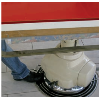
Der gelernte Werkzeugmacher Wornast hat einen Arbeitstisch mit dem Unterbau eines Zahnarztstuhls kombiniert, so dass er die Arbeitsplatte jederzeit und mühelos per Fußbetätigung in die gewünschte Höhe bringen kann
